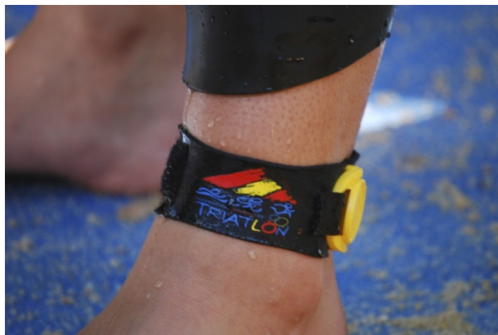
Figura 18. Chip electrónico, utilizado para el cronometraje de las competiciones.
